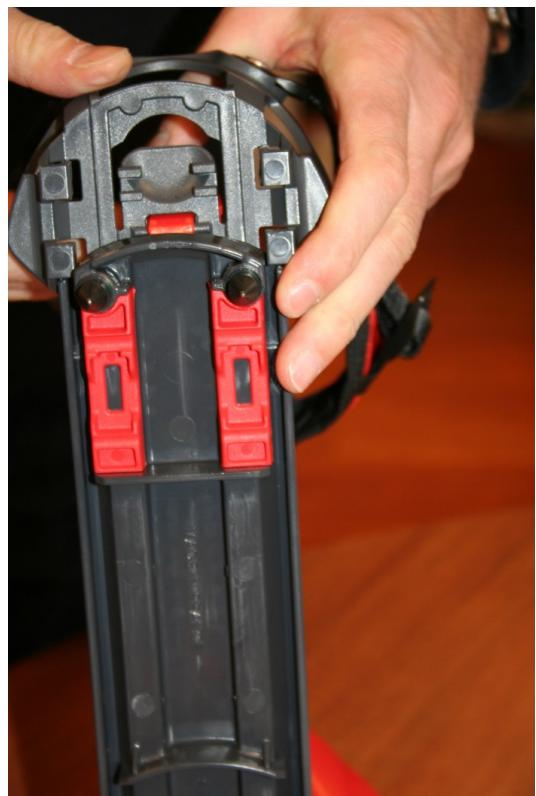
4) utiliser un maillet pour remettre la talonnière / use a hammer to re-engage the heel cup
