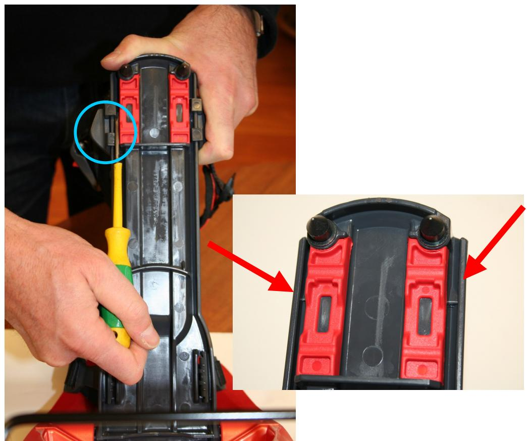
3) la talonnière peut être libérée de la platine / the heel cup can be pulled out from the plate
