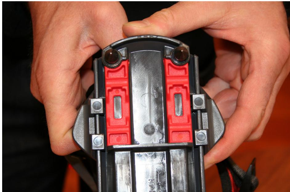
2) utiliser un tournevis et soulever les parties supérieures droite puis gauche de la glissière pour sauter le cran de la platine (indiqué par les flèches rouges) / use a screwdriver to lift up the right and left part of the slide in order to pass the safety stop (indicated by the red arrows)
